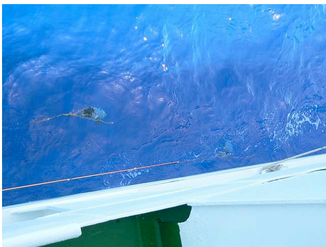
図 4 1.12 音響通信用送受波器の吊り下げ
