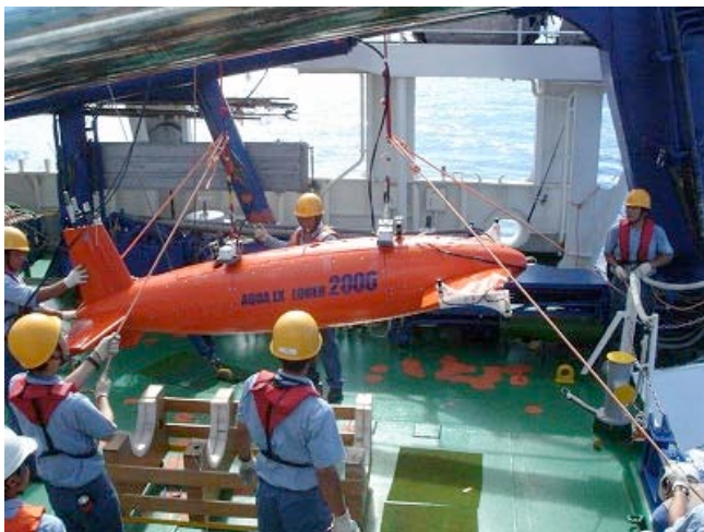
図 4.1.7 ロボットの吊り上げ
