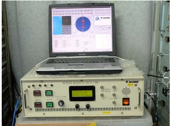
図 3.4 「なつしま」に搭載した AE2K 船上設備
