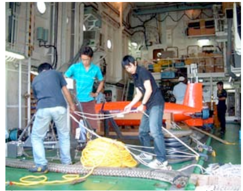
強風にそなえてハイドロフォンアレイを固縛する 2005年09月04日
