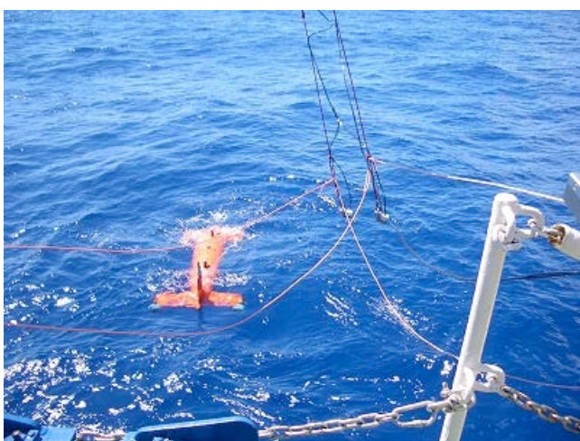
図 4.1.9 ロボットの着水・切り離し
