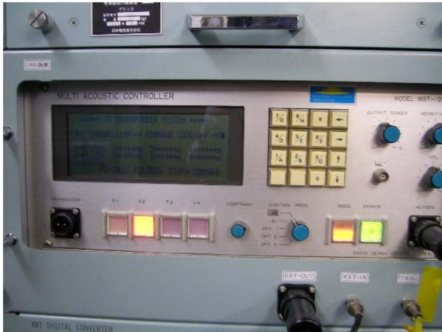
調査船なつしま常設の音響通信装置デッキユニット（海洋電子製）
