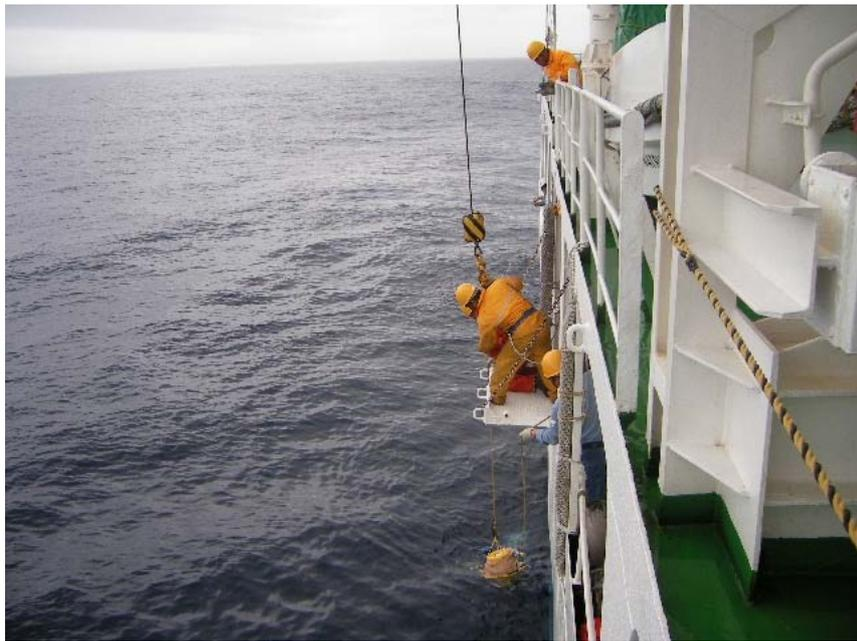
Site 202 での OBE 回収の様子。左舷側でクレーンにより OBE を釣り上げて、甲板へ張り出し部より引き込んだ。
