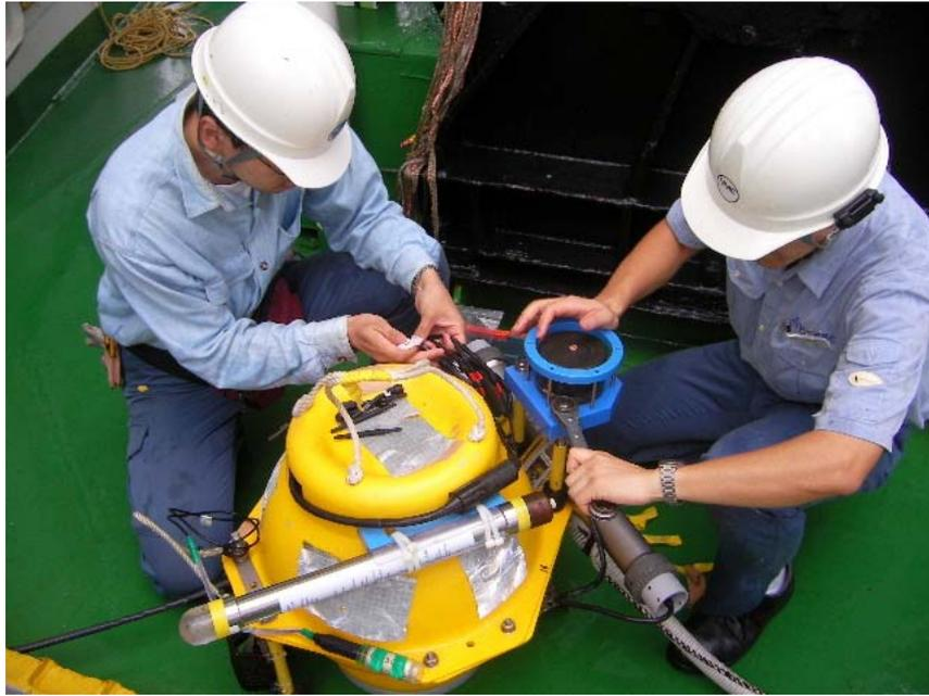
Site 202 から回収された OBE。OBEM とは違って、17 インチガラス球の上の浮力体（5 インチガラス球）は投入時から付いていない。
