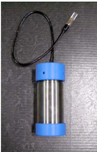
Fig. 12 ISFET pH sensor
