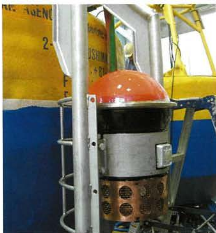
トライトンブイに取り付けられた海洋二酸化炭素分圧観測装置
