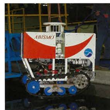
写真2 水槽でのクローラの試験風景
