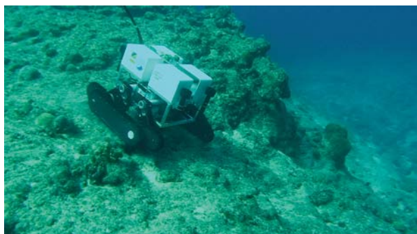
沖縄県黒島沖での試験。海底面の複雑な凹凸を克服し走行した。
