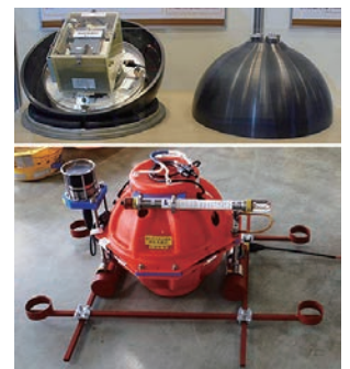
セラミックス製の球型耐圧容器(上)と超深海型海底地震計(下)。
