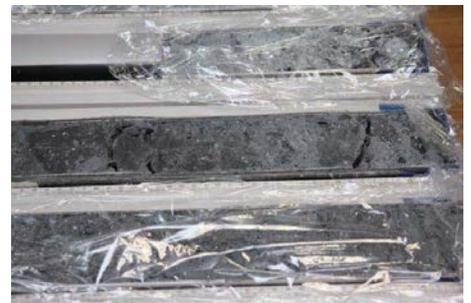
採取した海底下熱水鉱床の母体となる硫化鉱物濃集層の一部
