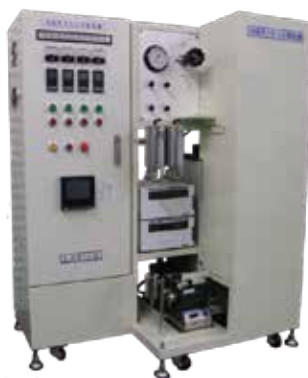
ナノエマルジョン製造装置「SFW-E40S」 画像提供：株式会社AKICO
