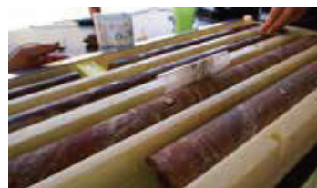
オマーンオフィオライト基底部の炭酸塩岩化した変かんらん岩(listwanite)
