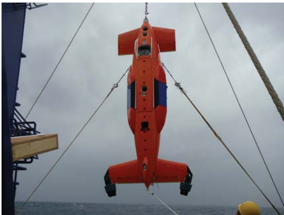
AE2000a：一本釣りによる吊り上げ
