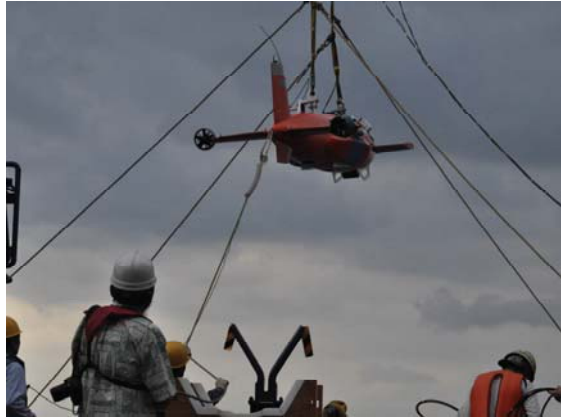
AE2000a：潜行準備完了、吊り上げ
