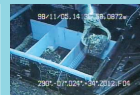
生物採取（左）と岩石採取（右）のサンプルバスケット
