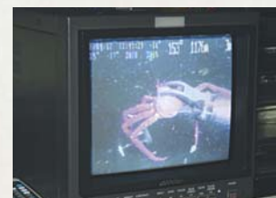
音響画像伝送装置により、「しんかい6500」のカメラがとらえた映像が静止画として船上に送られる
