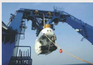
重さ約26トンの「しんかい6500」を吊り上げる巨大なAフレームクレーン
