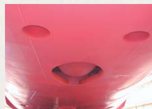
船底部の音響航法装置の送波器（手前の2つ）と水中通話機の格納式のソナードーム
