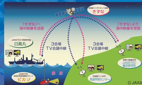
超高速インターネット衛星「きずな」を使用した行われた伝送実験の全体図
