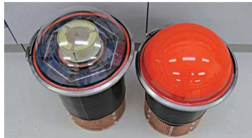
リチウム電池を使用したタイプ(右)、トライトンブイ用に太陽電池を用いたもの(左)
