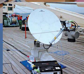
「白鳳丸」船上に設置された小型アンテナ。指向角度保持のため、動揺安定台の上に置かれている。
