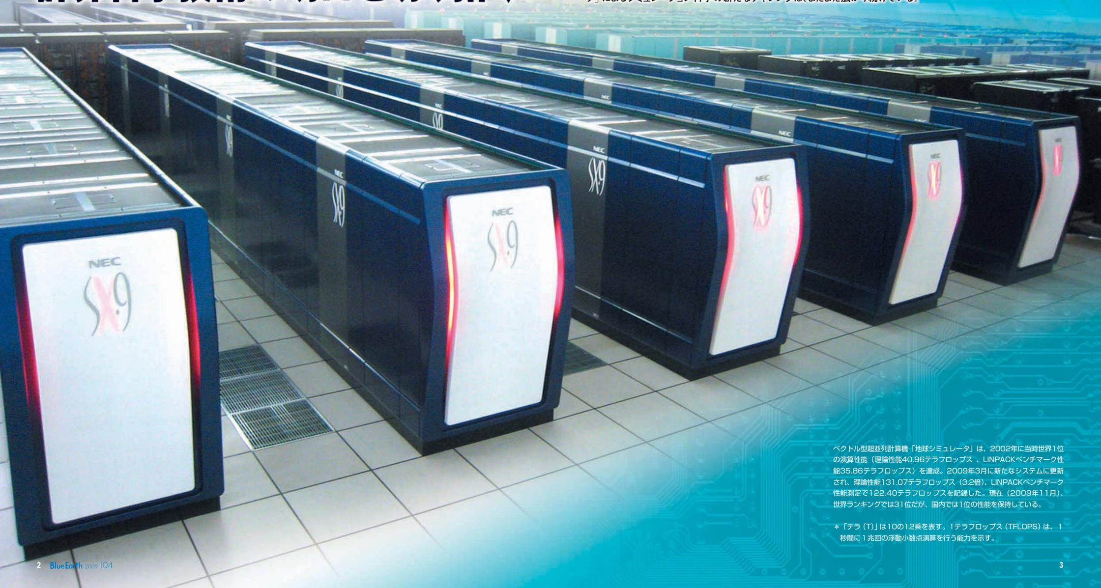
ベクトル型超並列計算機「地球シミュレータ」は、2002年に当時世界1位の演算性能（理論性能40.96テラフロップス、LINPACKベンチマーク性能35.86テラフロップス）を達成。2009年3月に新たなシステムに更新され、理論性能131.07テラフロップス（3.2倍）、LINPACKベンチマーク性能測定で122.40テラフロップスを記録した。現在（2009年11月）、世界ランキングでは31位だが、国内では1位の性能を保持している。
