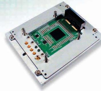
プロセッサボード（冷却器を取り外している）。中心の黒い部分が2cm×2cmに収められたベクトルプロセッサ。1チップで8ギガバイトの演算処理性能を持つ。
