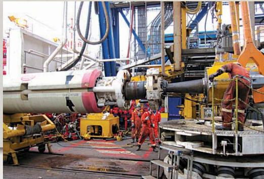
船上の作業の様子。写真左の円筒がライザーパイプ。
