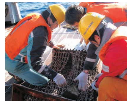
船上にて、鉄のバケツを海底で引きずり岩石を採取するドレッジ調査の作業をする様子。
