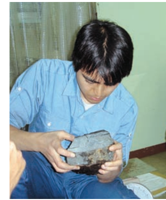
採取した石の外見は変色や汚損があるため、ダイヤモンドカッターで切断して内部を観察する。その後、研究室でプレバートなどに加工し分析を進める。
