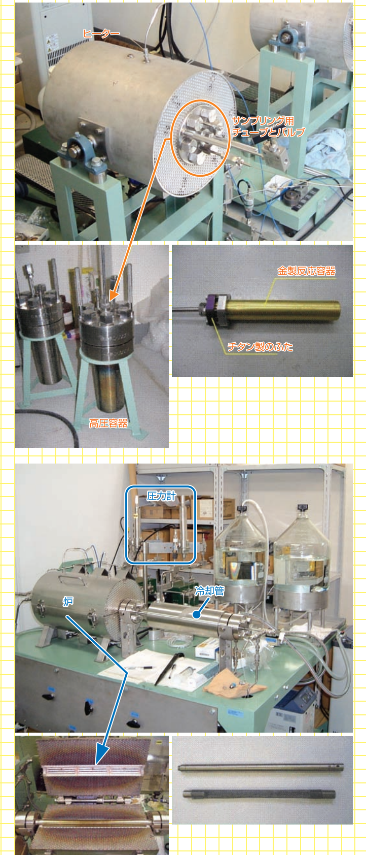
上図は、海水と岩石を300℃以上の高温、500気圧の高压下で「煮込む」ための、バッチ式高温高压反応実験装置。容器が金でつくられているのが重要なポイントだ。下図は実際に熱水がつくられる海底下の熱水反応を再現する、フローリアクター式高温高压反応実験装置。チタンの筒のなかで岩石と熱水を反応させ、できた熱水を噴出させる仕組み。
