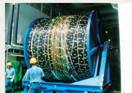
海底や海底下の地層で反射して海面に戻った音波をとらえる、長さ約5,000mのストリーマーカーケーブル。
