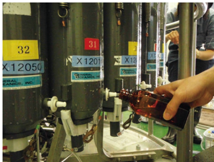
▲採水の様子 採水器から海水をボトルに採る。採水した海水の塩分を精密に測定し、CTDで計測する塩分を高精度で補正する
