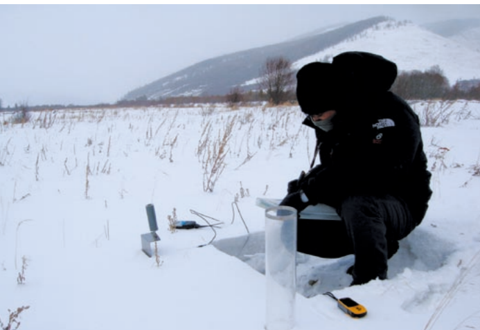
積雪量の観測。穴を掘って深さを測り、手前の筒で雪を採取して重さを量り、密度を求める
