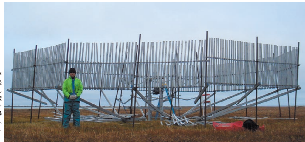
北極圏で使用されている主な降水量計による降水量の比較観測実験。手前からロシア（風よけ付き）、アメリカ、ヨーロッパ、カナダ（風よけ付き）の降水量計。国によって降水量計のかたちが異なり、強風下では捕捉する雪の量が変わる。実験の結果をもとに、各国の観測データを補正する。2004年2月、アラスカ・バローにて
