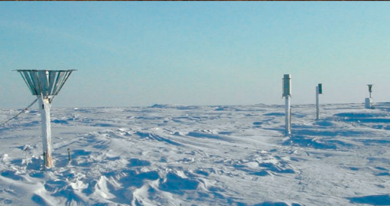
北極圏で使用されている主な降水量計による降水量の比較観測実験。手前からロシア（風よけ付き）、アメリカ、ヨーロッパ、カナダ（風よけ付き）の降水量計。国によって降水量計のかたちが異なり、強風下では捕捉する雪の量が変わる。実験の結果をもとに、各国の観測データを補正する。2004年2月、アラスカ・バローにて
