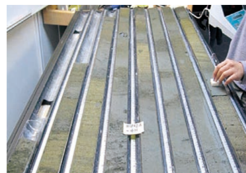
ベーリング海の掘削試料 掘削試料のなかの明るいオリーブ色の部分は、多数の植物プランクトンを含んだ間氷期のもの。灰色の部分は海洋循環が不活発だった氷期のときのものです。海水で運ばれてきた多数の粒子や石が含まれている
