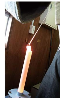
合成コマチアイトの作製 白金製のつぼのなかに岩石粉末と試薬を入れ、コマチアイトのもととなったマグマが生成されたのと同じ酸化還元状態にして1,600℃まで加熱し、合成コマチアイトをつくり出した
