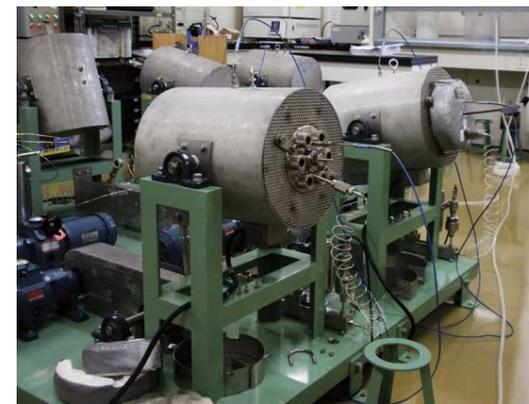
熱水実験装置 金製の容器のなかに岩石粉末と水を入れ、高圧下で加熱する。600気圧・600℃までの実験が可能だ
