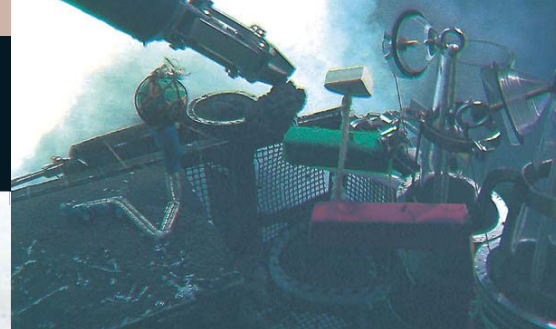
海底火山の火口近くで岩石を採取する「ハイバードルフィン」
