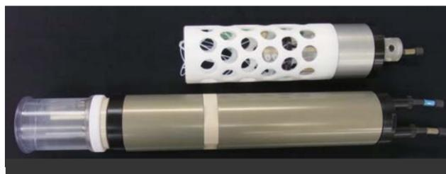
pH-CO<sub>2</sub>ハイブリッドセンサー。CO<sub>2</sub>濃度は、ガス透過膜を介して海水とpH指示薬をCO<sub>2</sub>平衡状態にさせ、pH指示薬の色変化を光学的に測定することで求める。pHは電極法で測定。CO<sub>2</sub>センサーとpHセンサーの耐圧容器を一体化することで、小型化に成功。センサー部の耐圧容器は、長さ60cm、直径8.4cm。UnRE#1とUnRE#2に搭載予定
