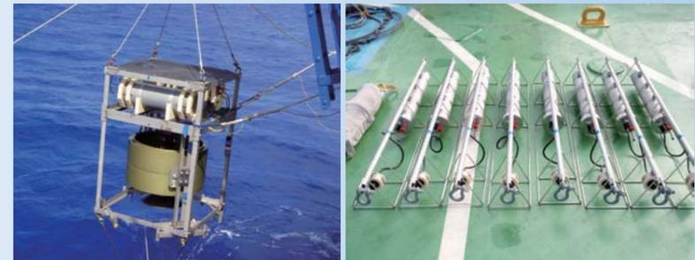
位相共役波を利用した長距離音響通信の海域試験の様子。左は送信機、右は受信機アレイ
