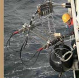
音波を発生させるエアガン投入の様子。調査海域は水深7,000mと深い。北極海用に開発していたエアガンでは出力が不足。急ぎよ出力の大きなエアガンを用意した
