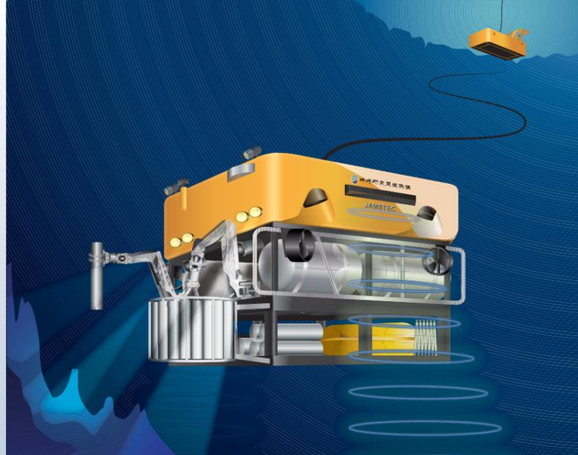
大深度高機能ROV「NEPTUNE」のイメージイラスト。母船とつながったランチャーにケーブルをつなぐ方式と、母船に直接つなぐ方式の2種類で運用できる。試料を採取した位置をcmオーダーで正確に特定できるように、ドップラー速度計などとJAMSTECで開発された世界最高性能の慣性航法装置を組み合わせた測位システムを搭載する
