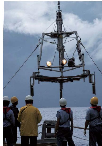
**ランダーの投下の様子** ランダーは水深1万1000mまで潜航可能。深海カメラを搭載し、着底する過程や着底後の周辺の様子を7時間以上にわたって連続撮影できる。表層50cmの堆積物を採取できる採泥器を3本搭載可能。今回の調査でも採泥を行った
