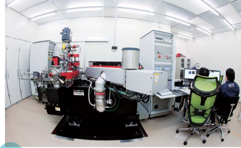
図5 超高解像度2次イオン質量分析計（NanoSIMS） 安定同位体で置換された栄養源を取り込んだ微生物を、最小50nm（1nmは100万分の1mm）の空間分解能で可視化し、栄養源の取り込み量を定量することができる
