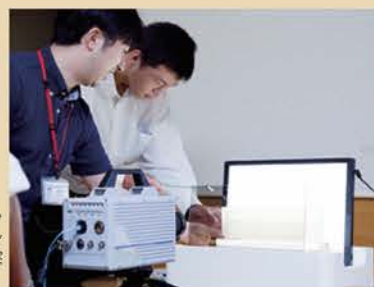
1秒間に1,000枚撮影できる高速度ビデオカメラで撮影し、波形を記録する
