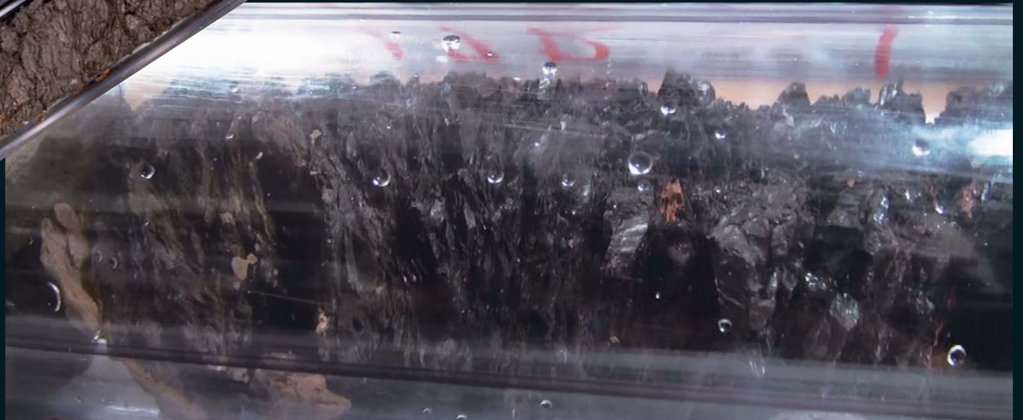
17Rの拡大像。魚のうろこのような形状が見える JAMSTEC/IODP 提供
