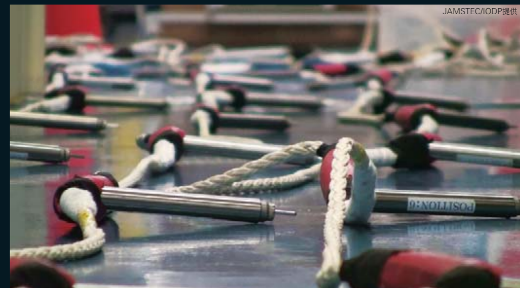
高精度温度計と長期孔内温度計の概略。55個の高精度温度計がひもでつながれ、断層周辺に集中して配置された
