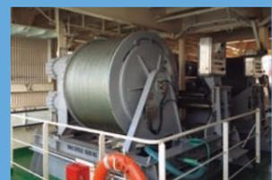
同軸ケーブルウインチ。波やうねりによる船体の動揺を自動的に補正制御できる。
