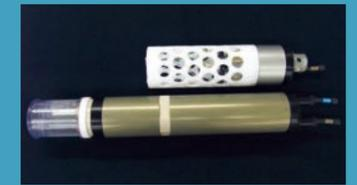
「じんべい」、「おとひめ」に搭載されているpH・CO<sub>2</sub>ハイブリッドセンサー。上はポンプユニットで、銀色の筒の中にはポンプやバルブ、指示薬が入っている。下はメインユニットで、透明部分にはpHセンサーが、グレーの筒にはCO<sub>2</sub>センサーが入っている。
