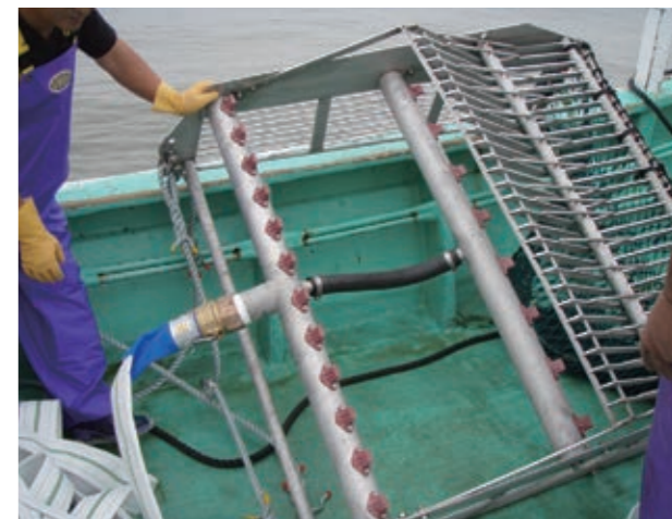
高圧の海水を噴出させて海底のホッキガイを掘り起こし、瓦礫があっても漁ができる噴流式具桁網を開発した。
