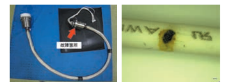
トラブルが発生した高電圧コネクタ (左) と見つかった線材の小さな傷。
