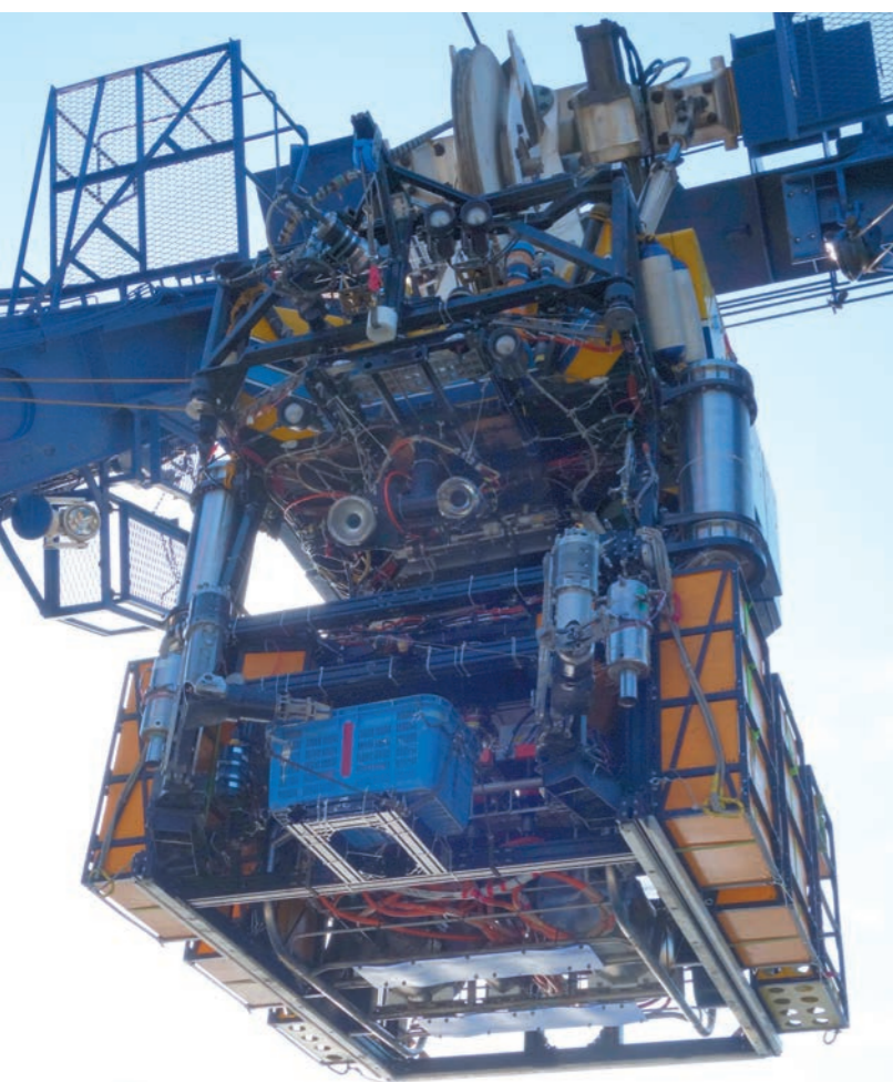
「ハイバードルフィン」に展張ケーブル（ボビン）を取り付ける作業の様子。
