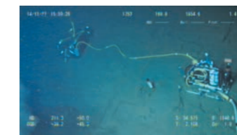
海底に設置された観測装置。左が地震計 (地動センサパッケージ)、右が水圧計 (水圧センサパッケージ)。
