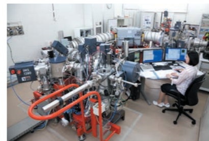
高精度大型2重収束セクター磁場質量分析計 (IMS-1280HR)。NanoSIMSよりさらに高精度な同位体分析を行う。
