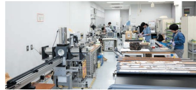
コア試料の非破壊計測を行うコアロギング室。
