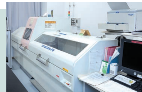
非破壊蛍光X線コアロガー。非破壊でコア試料を構成する主要元素の濃度変化を連続的に測定できる。
