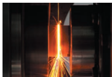
回転式高速摩擦試験機にセットされた岩石試料が回転により摩擦発熱している様子。実験でも、摩擦によって水素や二酸化炭素などのさまざまなガスが発生した。
