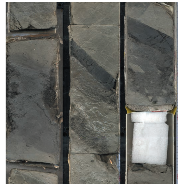
チェルンプ断層掘削コア試料の黒色ガウジ帯(黒く変色した部分)。黒色ガウジ帯のすべりで、微量元素や同位体の異常が認められた。
