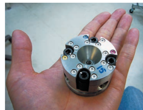
レーザー加熱式ダイヤモンドアンビル装置の仕組み（10ページ右図）。装置の直径は約5cm（左写真）。装置の中央部にダイヤモンド先端部に挟んだ微小試料（サイズはミクロンスケール）を置き（左下写真）、装置のネジを締めて加圧し、レーザーを照射して加熱する。扱う試料が小さいために、解析には、強力な高密度、さらに超高压高温条件を保ったまま解析が可能な大型放射光施設Spring-8の高輝度X線が用いられる。
