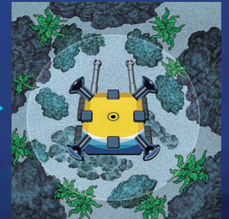
▲ モニター画面の映像。4台のカメラ映像を合成し、自分と周囲がひと目でわかる映像を作成して画面に映し出すとともに、障害物の情報を提供し、支援母船での操縦をサポートする。
