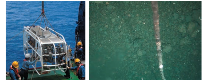
深海曳航調査システム「ディープ・トウ」。高感度カメラによる海底映像を母船で観察しながら後部に取り付けたドレッジ採岩装置によりピンポイントで溶岩を採取(撮影/アレックス・ニコル)。右は、今回の西之島調査で「ディープ・トウ」が撮影した海底の様子。
