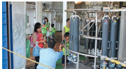
▲「みらい」に搭載された採水器。一度にいろいろな深さの海水を採取できる。
