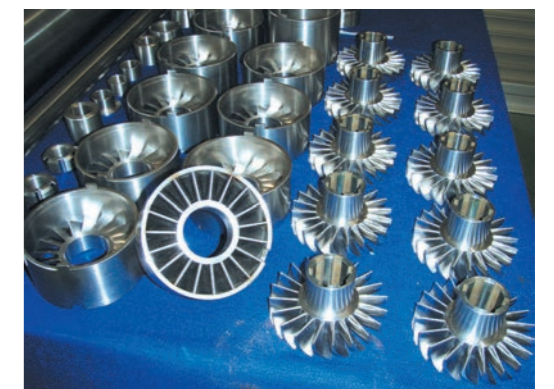
コアリングシステムに取り付ける泥水駆動タービンモーター(上)とタービンモーター構成翼(下)。
