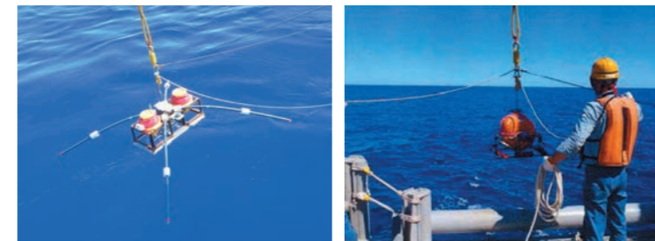
海底に投入される海底電位磁力計 (OBEM 左) および海底地震計 (OBS 右)。
