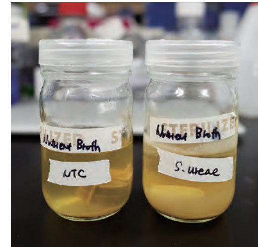
試料を入れた海水に微生物を加えると（右）、試料の表面に白い沈殿物（炭酸カルシウム）が形成された。12~13ページの写真は、この試料を顕微鏡で観察したものである。左は微生物を加えずに対照実験として行った結果で、沈殿物はほとんど見られない。
