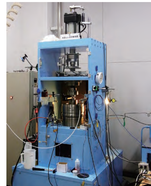
高速摩擦試験機。プレート境界断層を模擬した環境で実験を行うことができる。
