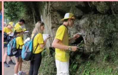
美里町桂畑での実技試験。地層の走向・傾斜を計測。
