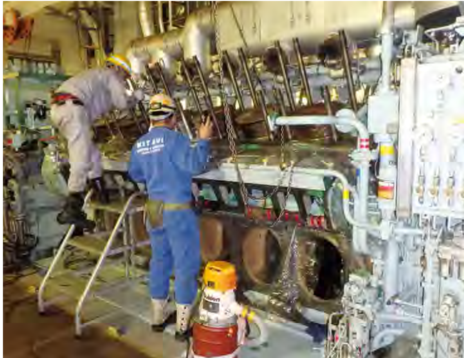
定期検査におけるエンジンの開放点検の様子。部品を取り外し、補修や交換を行う。
