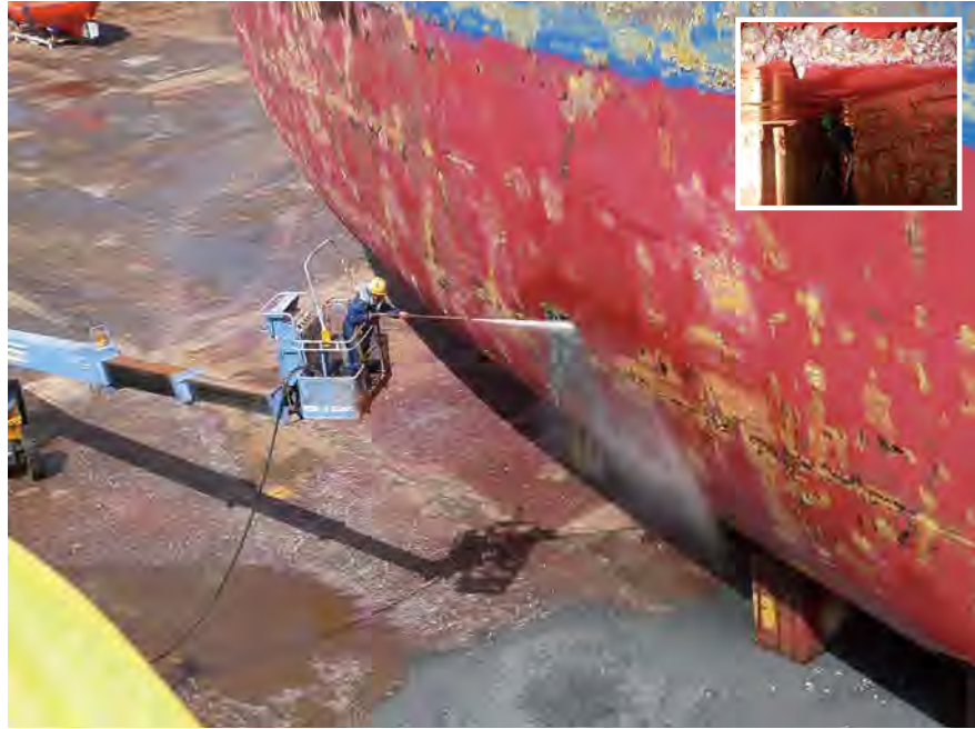
船底の洗浄作業の様子と、船底に付着した貝など(右上)。
