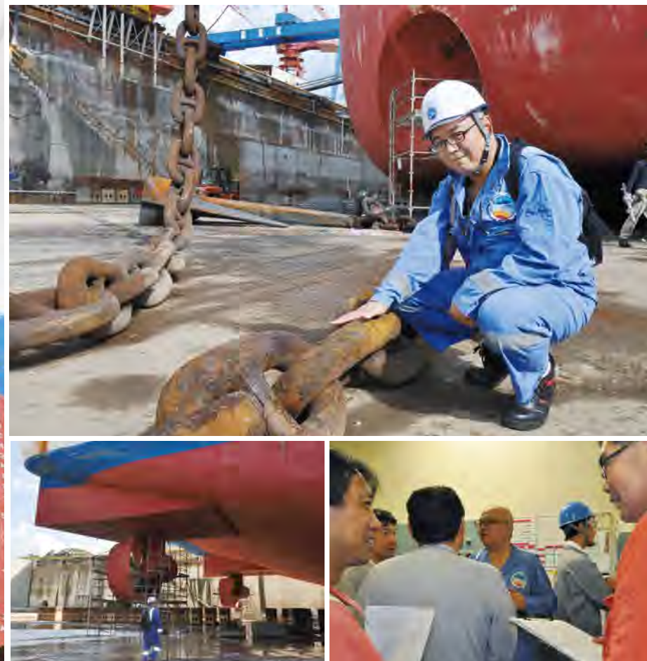
2017年10～11月に行われた中間検査での志賀さん。アンカーチェーンはすべて巻き出し、点検を行う（上）。アジマススラスタは船体の方向を360度変えることができる推進装置で、6基搭載されている（左）。志賀さんは「ちきゅう」の機器のうち特にエンジンとスラスタの保守整備を担当。右は、1日の作業前の打ち合わせの様子（中央が志賀さん）。
