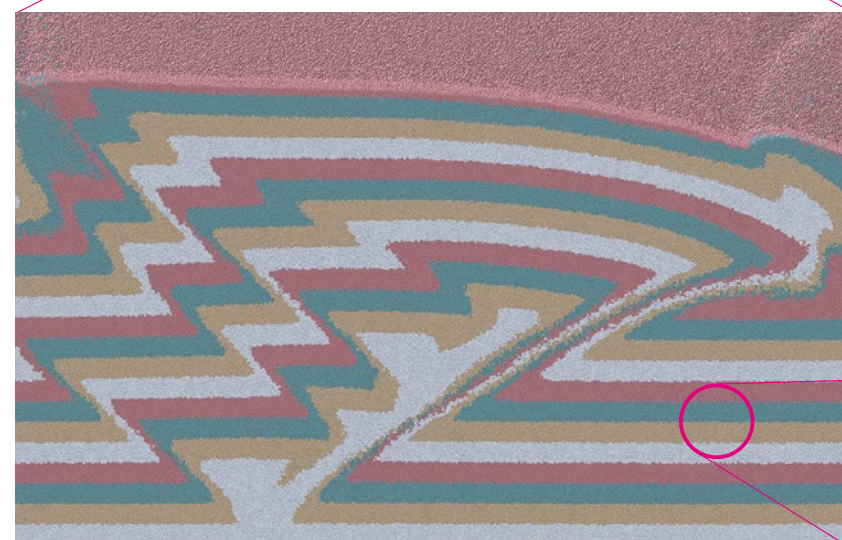
砂箱における断層形成の大規模計算。25億個の粒子を使用し「京」で計算を行った。拡大していくと、たくさんの粒子で構成されていることが分かる。粒子の直径は約100μm。実験室で行われた実際の砂箱実験の結果と比較すると、それらに特徴的な粒子の局所運動や断層境界、湾曲した地層構造などが再現されている。
