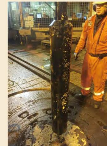
C0010から回収された簡易型孔内観測装置。
