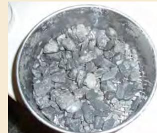
カッタニングス。掘削の際に生じる堀りくずで、掘削孔内の地層の組成や強度などの情報を得ることができる。
