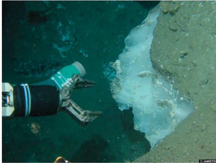
メタンハイドレートは、海底に露出して塊状になっているもの、海底下の泥や砂のなかで塊状になっているもの、海底下で塊にならずに泥や砂と混ざっているものという3種類の状態で存在している。表層型（塊状）の写真は、新潟県上越市北方沖にある上越海盆で撮影されたものである。写真提供（砂層型、塊状型）：メタンハイドレート資源開発研究コンソーシアム
