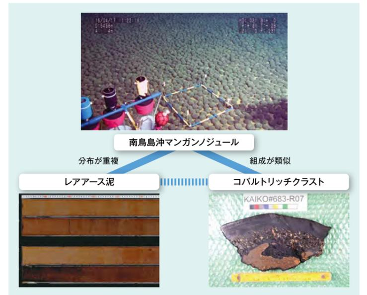
マンガンノジュール、コバルトリッチクラスト、レアアース泥はいずれも酸化物を主体とする鉱物資源である。南鳥島沖のマンガンノジュールは、拓洋第5海山のコバルトリッチクラストと組成が似ていた。また南鳥島沖のマンガンノジュールとレアアース泥は分布域が似ている。これら3種の鉱物資源の成因が、マンガンノジュールを手掛かりとして包括的に理解できる可能性があると考えられている。
