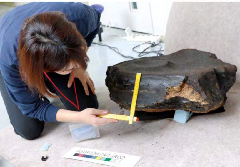
拓洋第3海山の水深3,200m付近で採取された、厚さ約13cmのコバルトリッチクラスト。
