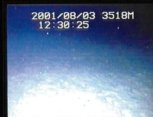
今回の潜航試験で伝送されてきた海底付近の音響画像。日付に並んで、水深を示す「3518M」の数字が見える
