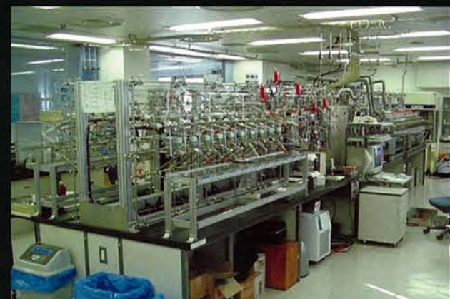
採取された海水を質量分析計にかけるために前処理を施す装置(むつ研究所)
