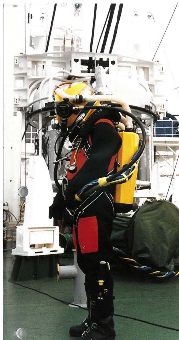
1985年から開始した「ニューシードピア計画」では、300mの深海潜水実験をおこなった。31気圧、水温6℃という過酷な環境への潜水をおこなうためには、写真のような重装備が必要。潜るだけでなく減圧作業もたいへんで、12日間もかかる
