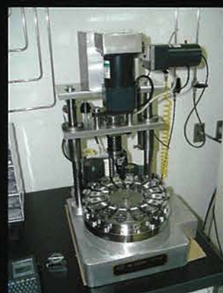
前処理された資料をプレスして一定の大きさに固形化する(むつ研究所)
