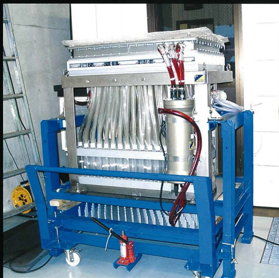
採取された海水を質量分析計にかけるために前処理を施す装置(むつ研究所)
