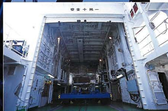
後部甲板にある「しんかい2000」搭載用の台座。がっしりとした造りで重さは約7トン。この上に空中重量が24トン近い「しんかい2000」が載る。格納庫から台座を引き出すワイヤも太い
