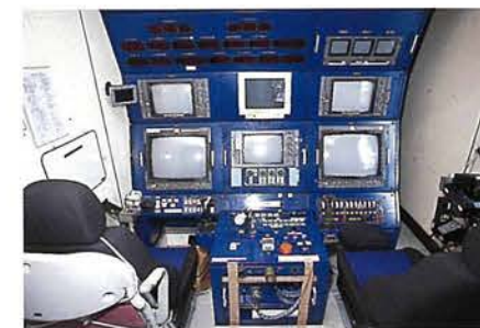
船上に設置された無人探査機「ドルフィン-3K」の操作室内部。頑丈なコンテナを使用しており、ここにパイロットとオペレーター、研究者が乗り込んで海中の「ドルフィン-3K」の操縦をおこなう
