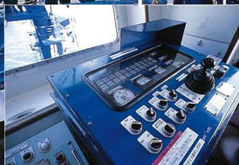
後部操舵室から眺めたAフレームクレーン。操舵室の内部には着水揚収作業、「ドルフィン-3K」ケーブル操作の操作盤もあった
