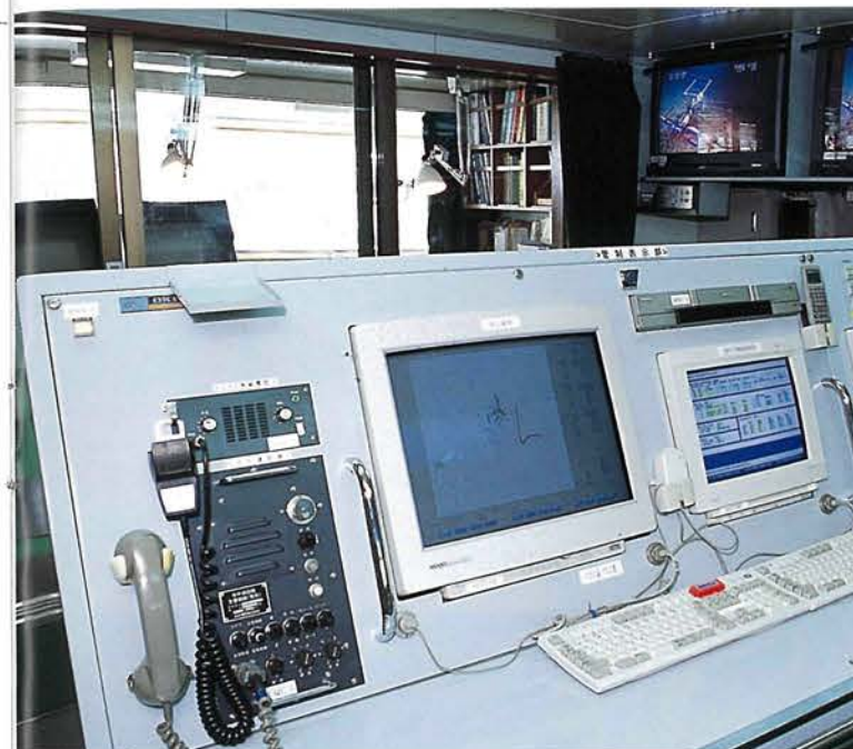
総合指令室にある「しんかい2000」潜航調査のための管制表示部。コンピュータの機能向上と小型化などで、就航時に比べるとずいぶんスリムになった。その分、ここには多くの研究者やスタッフが入ることができるようになった
