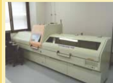
XRFコアロガー。X線を使ってコアに含まれる多元素を同時に連続測定し、イベント層等を検出。
