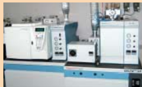
有機地球化学実験室のガスクロマトグラフ燃焼質量分析計。同位体比や放射性炭素年代を測定。
