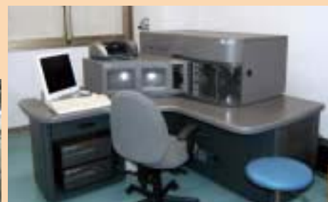
自動細胞解析装置（セルソーター）。バイオ実験室には遺伝子抽出やDNA解析を行う機器が充実。
