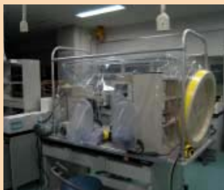
バイオ実験室に置かれた嫌気グローブボックス。酸素のない嫌気条件下で無菌処理を行う機器。
