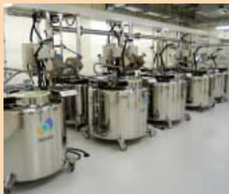
液体窒素凍結保存システム。タンク内は-200℃で、酸素に触れさせずに微生物試料を長期保管。
