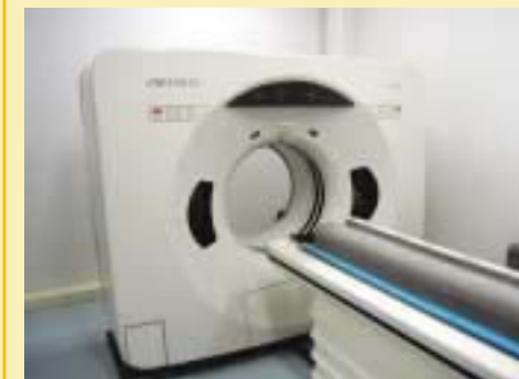
X線CTスキャナシステム。医療用と同様のシステムで、コアの内部構造を三次元的に捉える。
