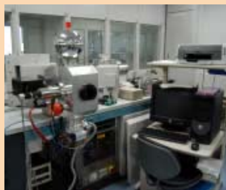
無機化学実験室の表面電離型質量分析計。炭素などの同位体比や微量金属元素の含有量を用いて、物質循環過程の解明や環境復元を行う。
