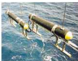
圧搾空気によって人工的に地震波を発生させるエアガン
