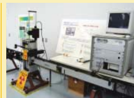
コアの物理特性を調べるマルチセンサーコアロガー。5つの物性センサーで連続的・自動的に測定。
