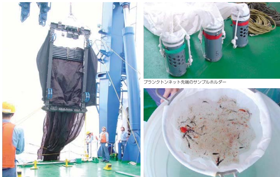
船のフレームから海上に振り出されるネットシステム。「振り出し、Slow!」 得られたプランクトンやマイクロネクトンのサンプル
