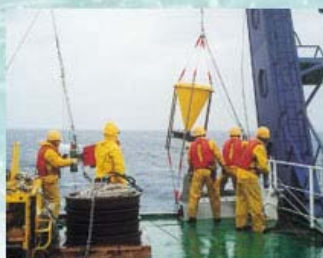
セジメントトラップ（海中に係留し、沈降粒子を捕集する装置）の設置作業
