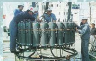
「かいよう」船上でCTDロゼット採水器の調整を行う様子
