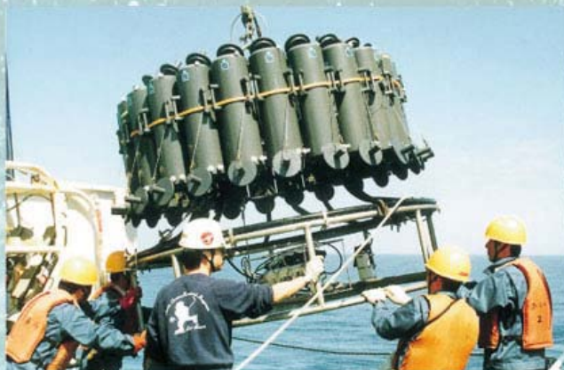
20リットルニスキン採水器24本が装着されたCTDロゼット採水器。下部にCTD、光透過度計、光度計を搭載。この研究のために新たに準備された
