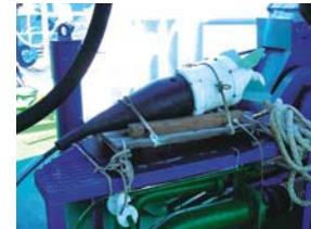
深海調査研究船「いかい」に搭載された磁力計（センサー部）
