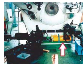
1994年の大西洋調査のときに「しんかい6500」に搭載された深海磁力計（矢印）。海洋地殻に近い海中で観測することにより、高精度な地磁気データを得ることができる
