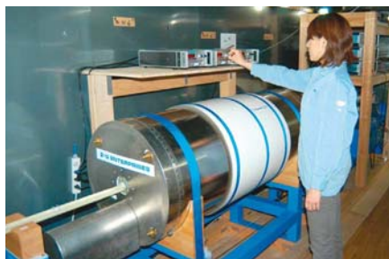
高性能・高効率の超伝導磁力計は、古地磁気学研究的の進展に大きく貢献した
