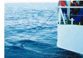
船体磁化の影響を避けるため、磁力計は船体から数百m離して曳航
