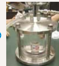
圧力実験装置の内部に水を満たし、100気圧をかけると、発泡スチロール容器が見る間に縮んでいった
