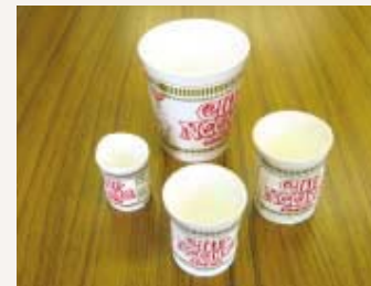
発泡スチロール製のカップめん容器に圧力をかけると、空気層がつぶれて小さく縮む。写真真の容器は元の大きさ。時計回りに深度500m、1,000m、6,500m相当の圧力をかけて縮んだ容器
