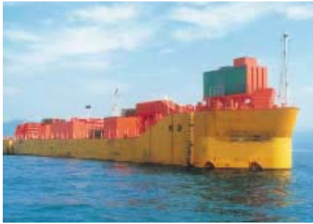
浮体式波力発電装置「海明」 1978～1986年まで、山形県鶴岡市由良沖3kmの海上で発電実験を行った
