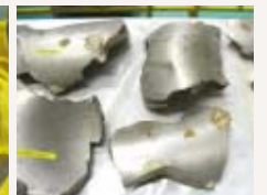
「しんかい6500」の耐圧殻（乗員室）開発時に、加圧実験で破壊したチタン合金球の破片
