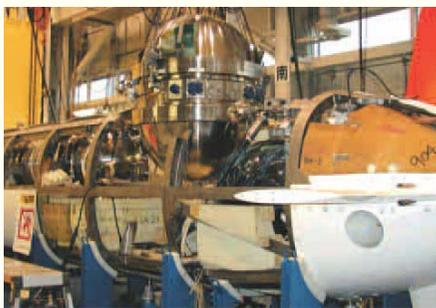
燃料電池はチタン合金製の容器に格納され「うらしま」に搭載されている
