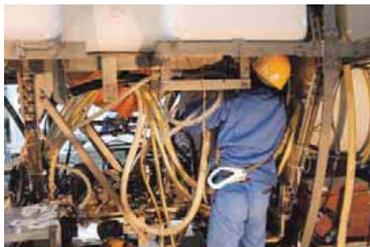
油漬電線（写真中央）のホースも劣化が進む前に交換
