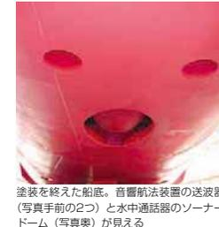
塗装を終えた船底。音響航法装置の送波器（写真手前の2つ）と水中通話器のソーナードーム（写真奥）が見える
