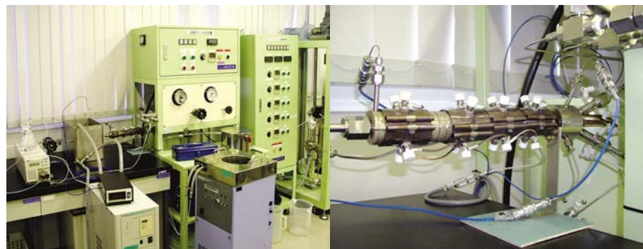
(写真5) 流通型反応装置 熱水噴出孔の高温・高圧環境を実験室内で再現する装置。超臨界水中でアミノ酸がつながりタンパク質が生成しうることがわかった
