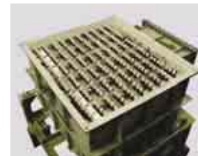
運用コストの軽減に大きく貢献した「しんかい6500」に搭載される油浸均圧リチウムイオン電池
