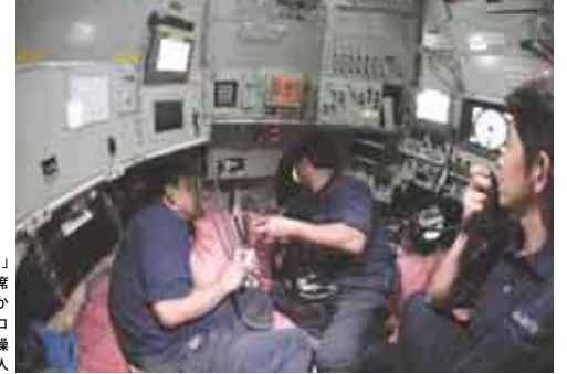
「しんかい6500」の耐圧殻内。座席はなく、丸い窓から外を見ながらコントローラーで操船する。定員は3人
