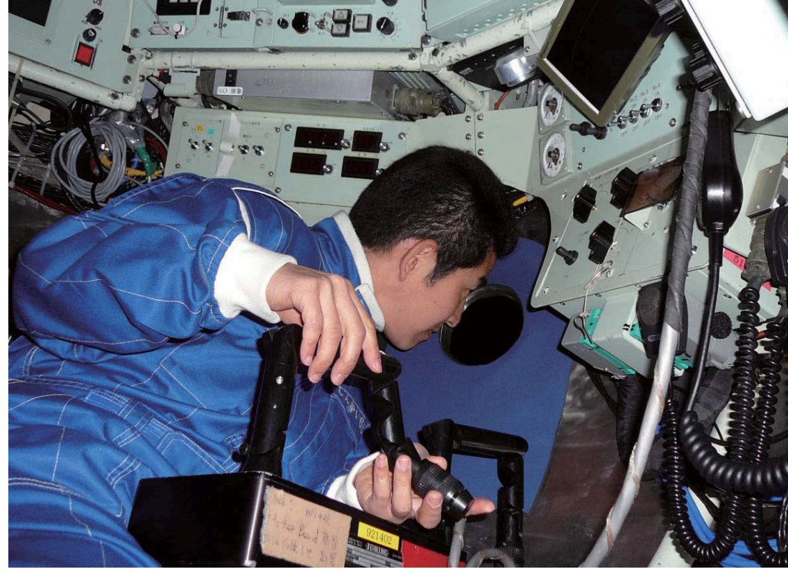
「しんかい6500」耐压殻内で、マニピュレータを、マスターアームと呼ばれるリモコンで操作する柳谷副主任。「マニピュレータでブラックスモーカーから熱水を採水するときは、温度計を見ながら、煙に隠れて見えない数cmの熱水孔に、採水口をセットします」
