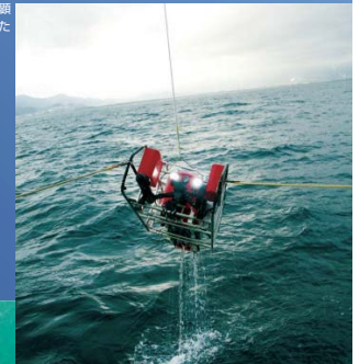
深海現場調査用実体顕微鏡(VPR)を搭載した「PICASSO」
