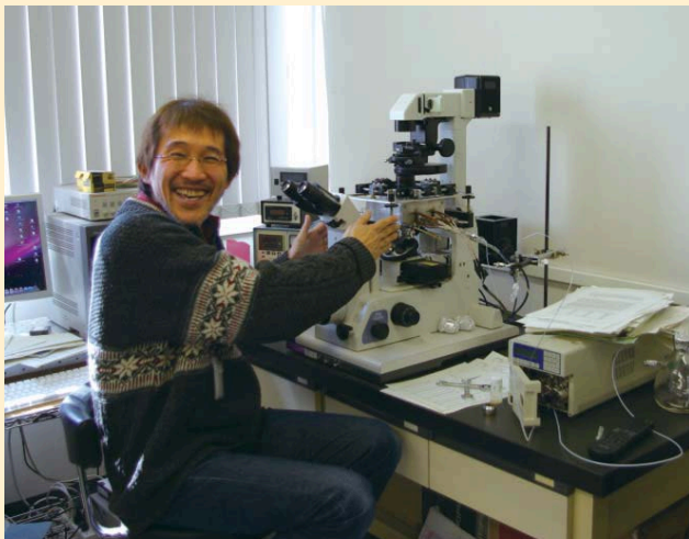
出口GLと高温・高圧顕微鏡1号機。1号機の開発過程では、のぞき窓に使用した厚さ約2mm、0.5カラットの天然ダイヤモンドにひびが入ってしまったこともあった
