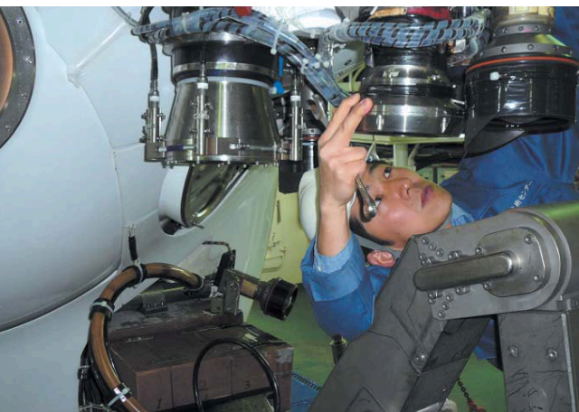
「しんかい6500」のデジタルスチールカメラの整備。「スチールカメラ時代から担当して いた機器なので愛着があります」
