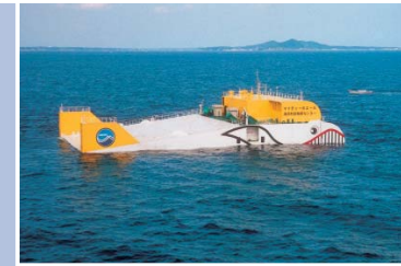
宮崎センター長は、1970年代から波のエネルギーを利用して発電を行う「波力発電」の研究開発を進めてきた。コストが高いなどの問題があり停滞していたが、最近ではアメリカやイギリスで実用化に向けた動きがある。「ようやく芽が出てきました。私たちが乗り越えました」と笑う。写真は、マイナーホールウェイ波力発電装置。実用化を目指したプロトタイプとして、1988年から2002年まで三重県の五ヶ所湾の沖合に設置され、発電を行った。
