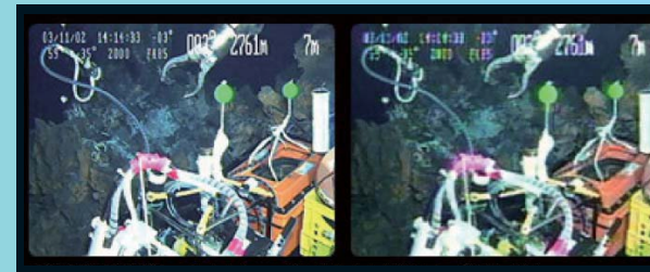
「しんかい6500」から伝送された画像 左: 太平洋マリアナトラフの潜航調査で撮影された伝送画像 右: 海上の母船で受信した画像
