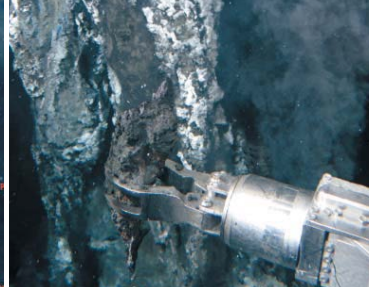
チムニーのサンプリング。「チムニーは非常にもろいため、マンビュレータで崩さないように慎重に採取します」
