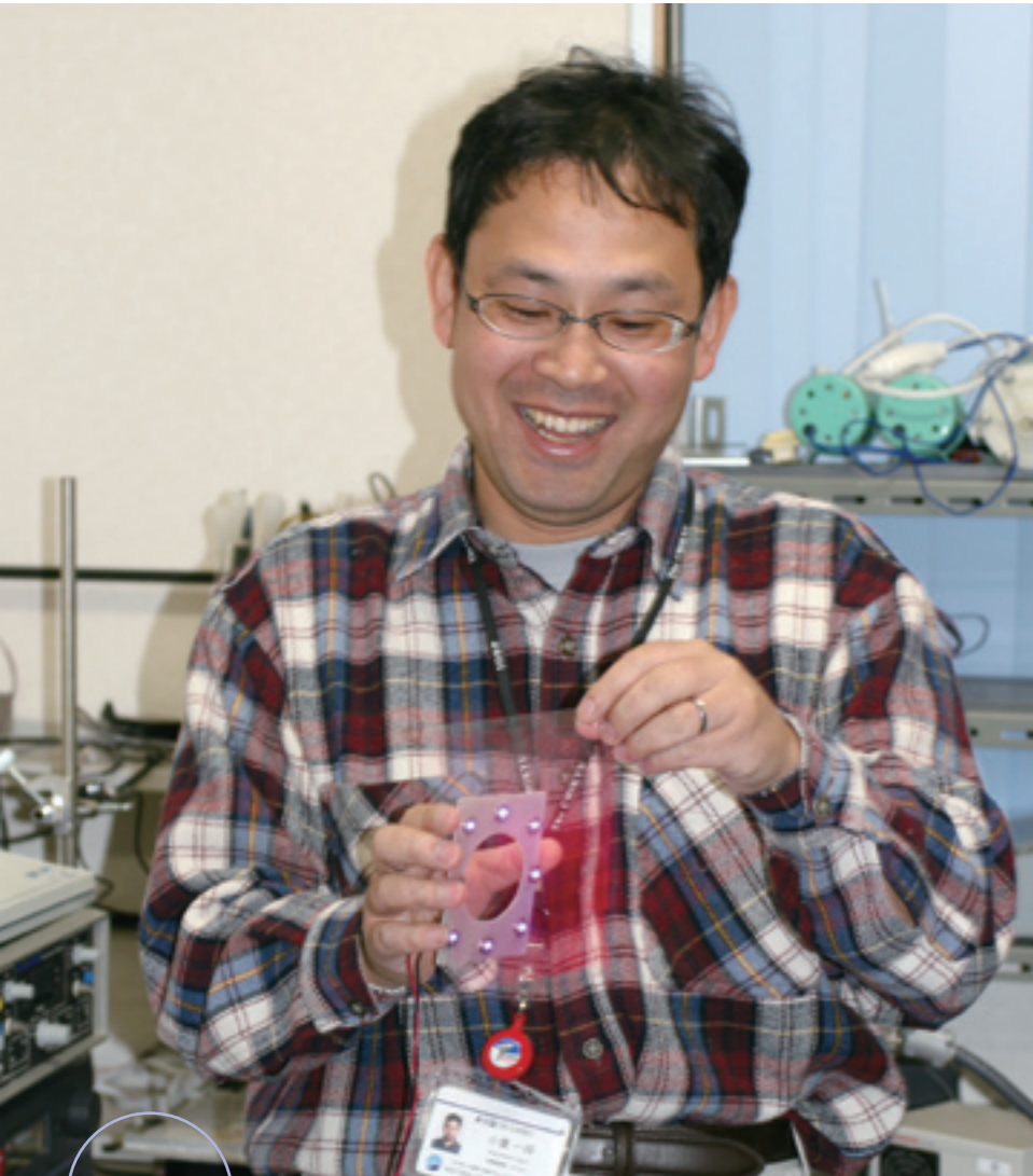
開発した酸素センサーの色素フィルムに光を当てて、リン光を発光させている様子
