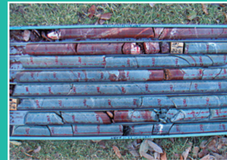
地下211～218mから得られた赤鉄鉱化した玄武岩のコア試料
