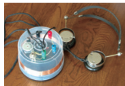
小栗技術研究主任が自作したゲルマラジオ。「仕事の息抜きにつくりました。CD-Rの空きケースにコイルを巻いてあります。ゲルマラジオは電子工作の最も基本的なもので、アンテナとアースをつなげることで、電池を使わずにラジオ放送を受信できます」
