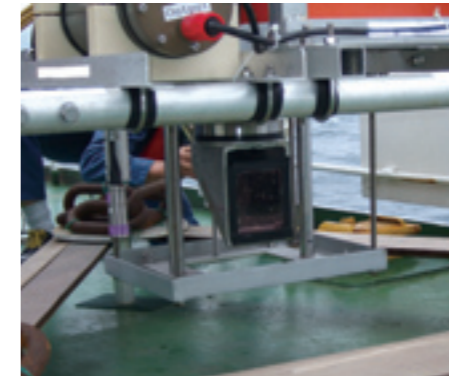
酸素センサーの色素フィルムがはられた部分。この部分を海底に突き刺して、海底の酸素濃度分布を測定する
