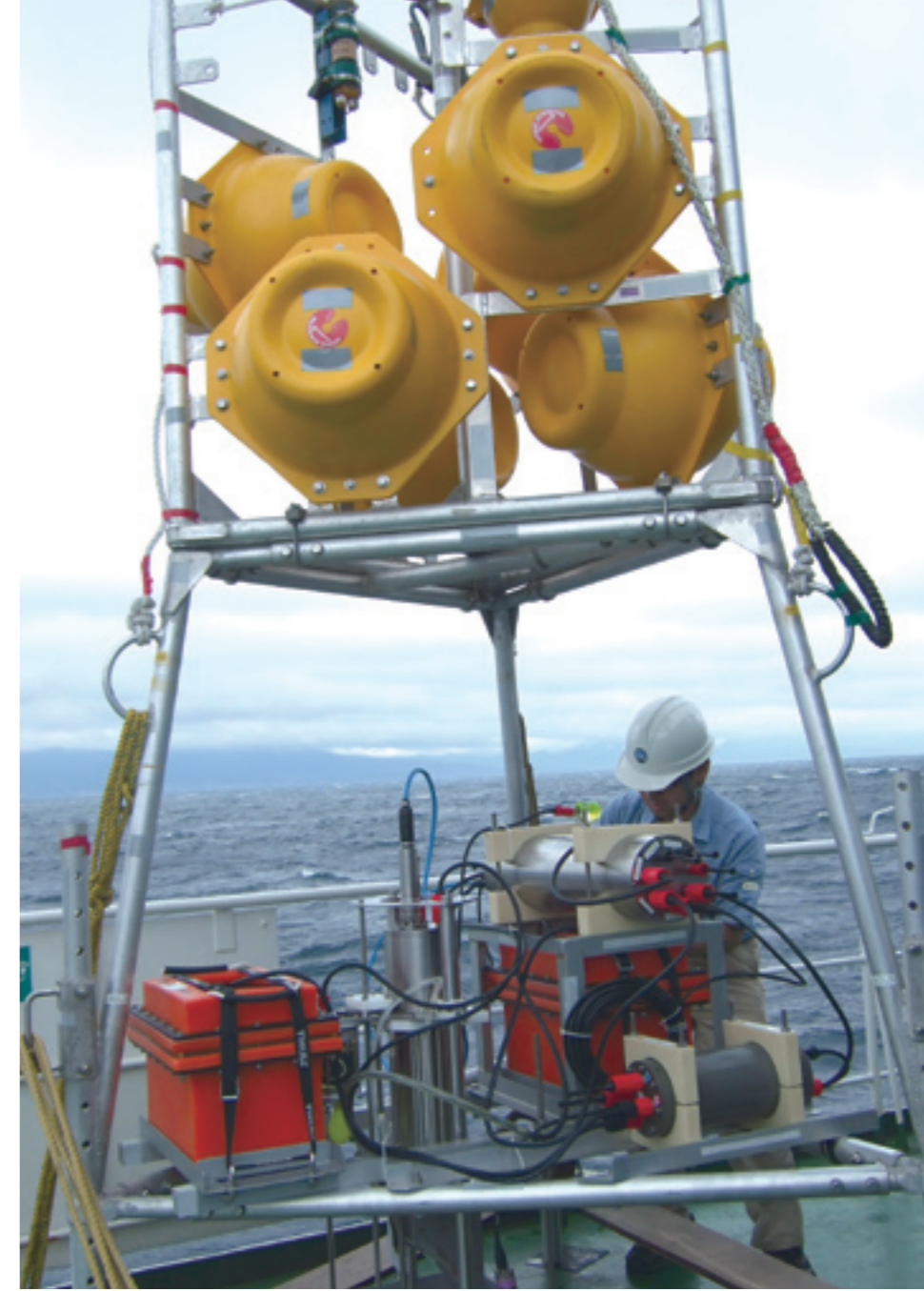
船上で酸素センサー（二次元酸素濃度測定装置）の最終調整をする小栗技術研究主任。装置は「ランダーシステム」と呼ばれる水中エレベーターに搭載され、海底に投入される
