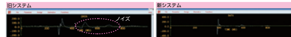
図5 新旧システムの構造探査データ 新システムではノイズが抑制され、細かい構造や深いところの構造もはっきりと描き出されている
