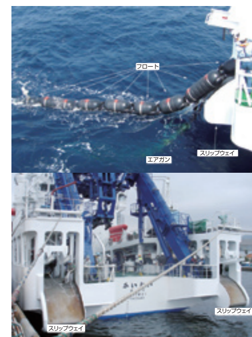
図6 エアガンの投入 [三浦 (2008) より] 8台×4列の計32台のエアガンを海に投入するため、「かいいい」の改造を行い、スロープを増設した
