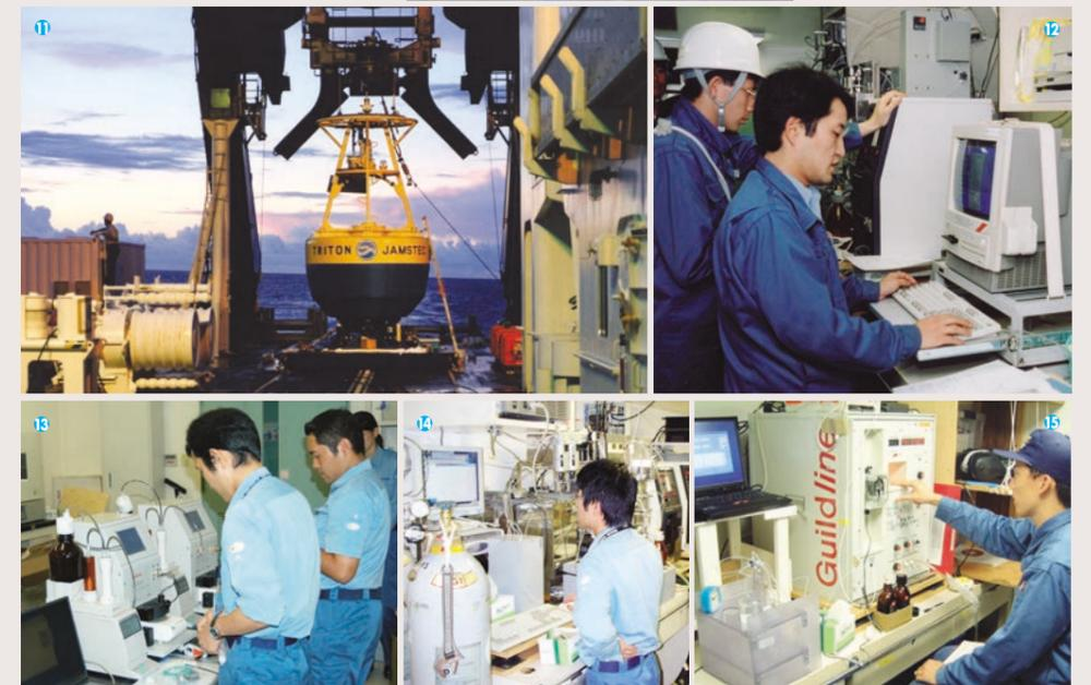
⑪ 大型パイプの格納、洋上組み立て、測器調整、投入・揚収を行うための充実した設備を持つ「みらい」は、トライトンパイプの展開に大きく貢献している ⑫ 航行中、自動連続で採水した海水を分析する、表層海水分析室 ⑬ 研究室で溶存酸素の測定装置をチェック ⑭ 分析室に並ぶ全炭酸の分析機器 ⑮ サリノメータの代表的な機器「オートサル」で塩分を測定
