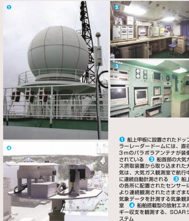
① 船上甲板に設置されたドップラーレーダードームには、直径3mのパラボラアンテナが装備されている ② 船首部の大気ガス採取装置から取り込まれた大気は、大気ガス観測室で航行中に連続自動計測される ③ 船上の各所に配置されたセンサーにより連続観測されたさまざまな気象データを計測する気象観測室 ④ 船舶搭載型の放射エネルギー収支を観測する、SOARシステム
