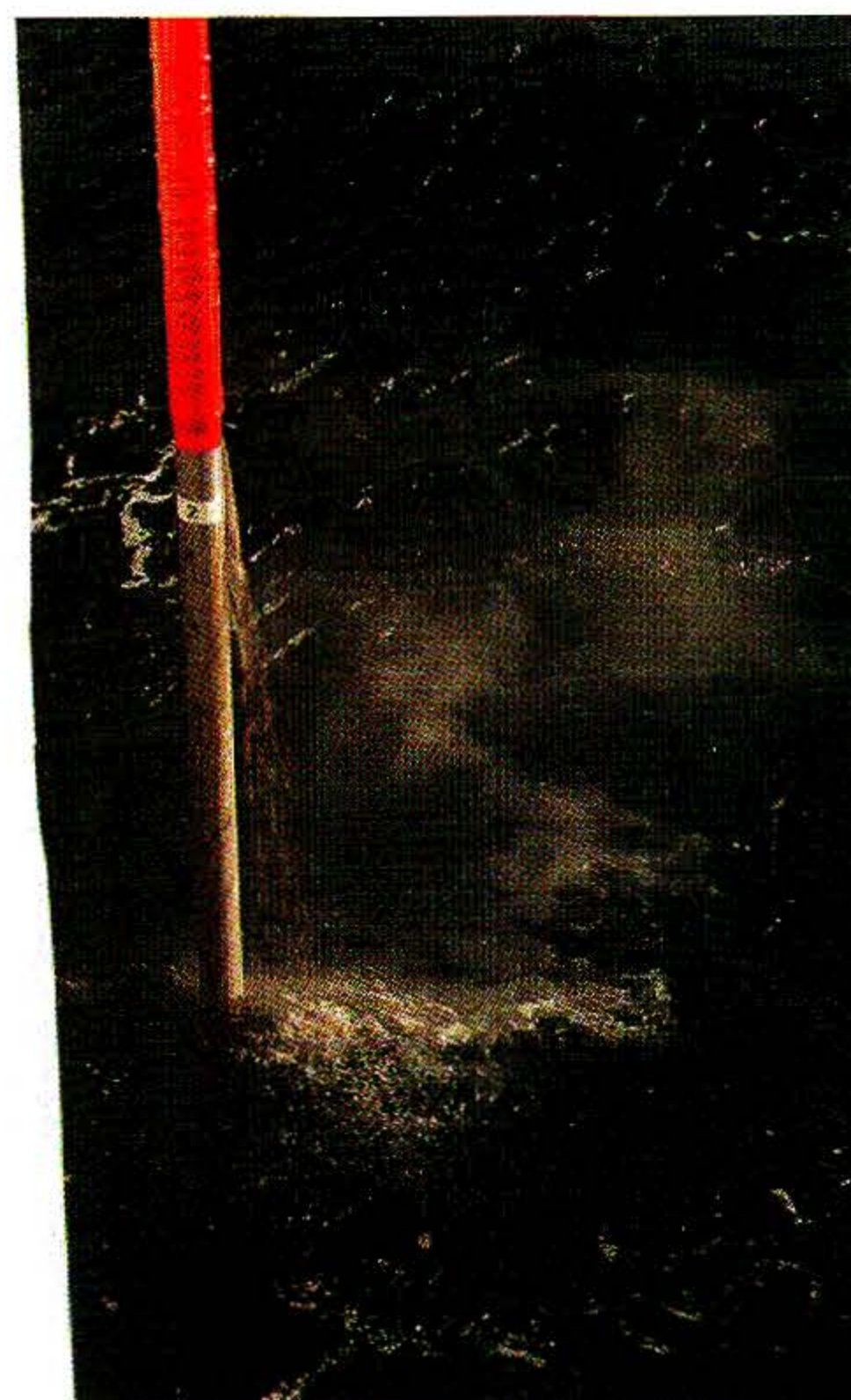
写真8 接続スリーブから試料が流出している採泥管 Photo 8 Samples was escaping from connection sleeve and pipes.
