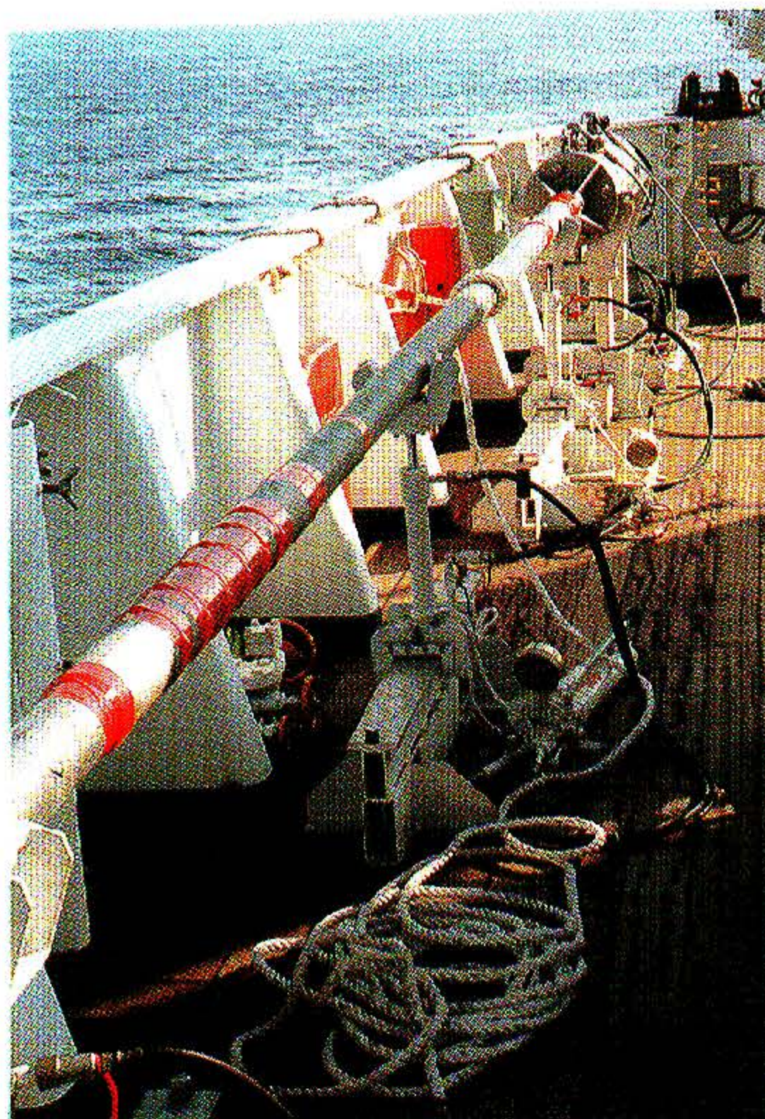
写真10 右舷側に組み立てた20メートルピストンコアラーと油圧ジャッキ Photo 10 Twenty meters piston corer and hydraulic jacks on the starboard.
