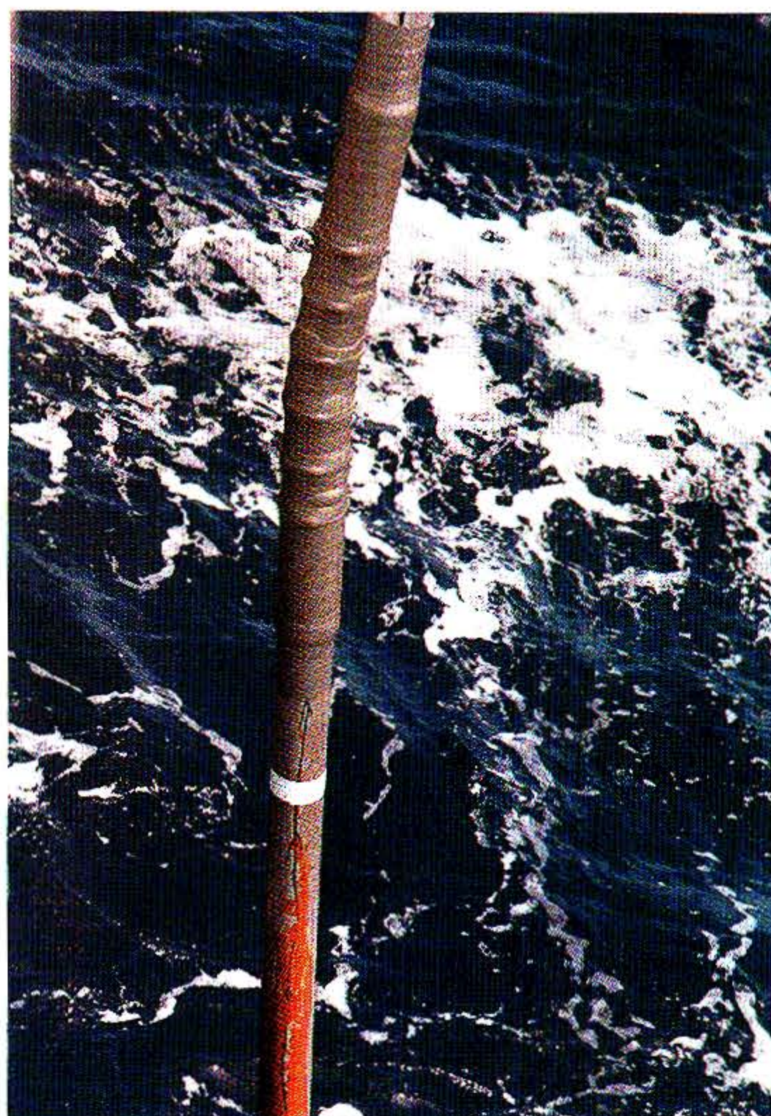
写真5 曲損した接続スリーブ Photo 5 Bended connection sleeve.
