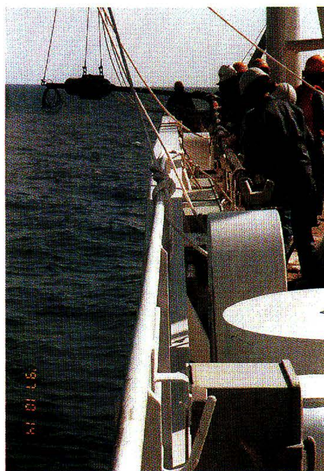
写真4 右舷側で採泥管が曲損して揚収された20メートルピストンコアラ－ Photo 4 Recovery of twenty meters piston corer that pipes was bended on the starboard deck.
