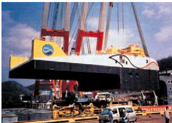
写真7 建造ドックからフローティングクレーンによる着水作業 Photo 7 Launching work by floating crane from dock
