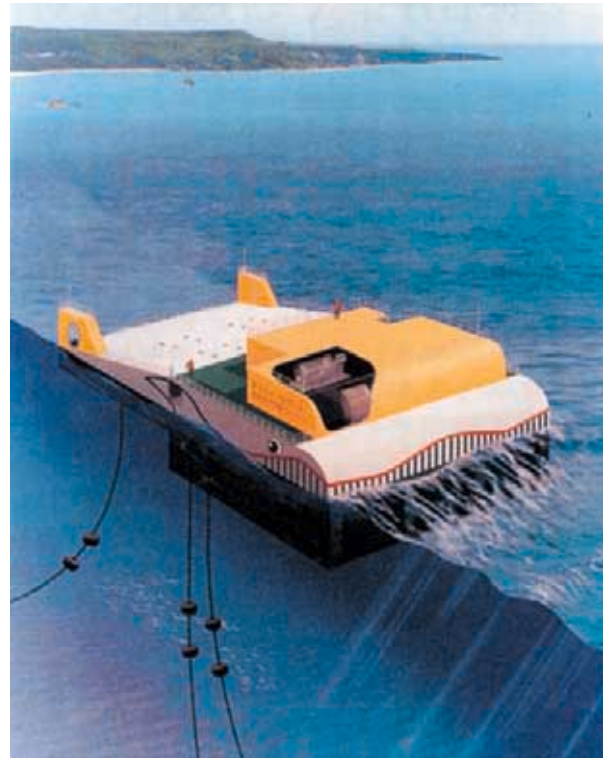
写真1 沖合浮体式波力装置「マイティーホエール」 Photo 1 Offshore Floating Type Wave Power Device "Mighty Whale"
