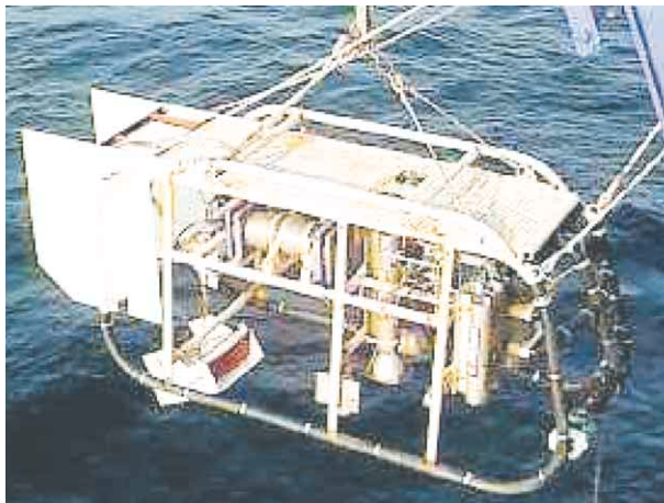
図6-2 4,000m級ディープ・トウカメラ Fig. 6-2 4,000m class Deep Tow camera
