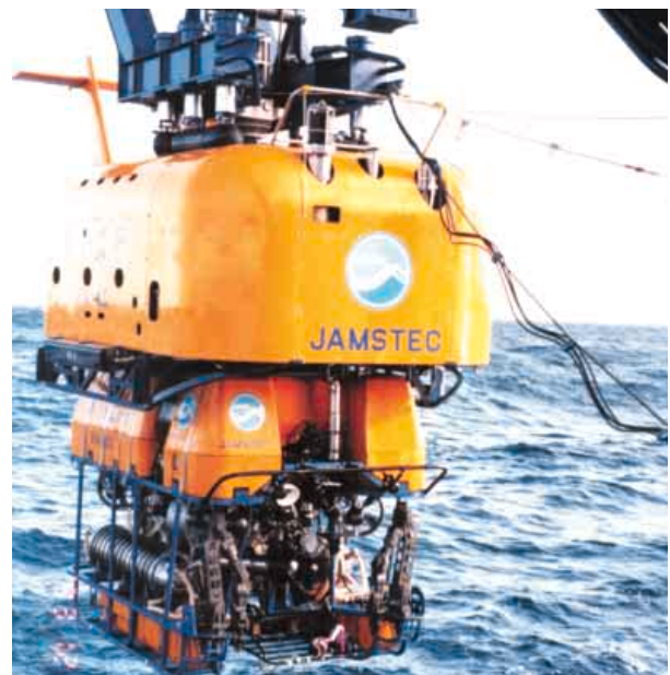
図5 10,000m級ROV「かいこう」のランチャー(上)とビークル(下) Fig. 5 Launcher (upper) and vehicle (lower) of the full ocean depth ROV Kaiko.
