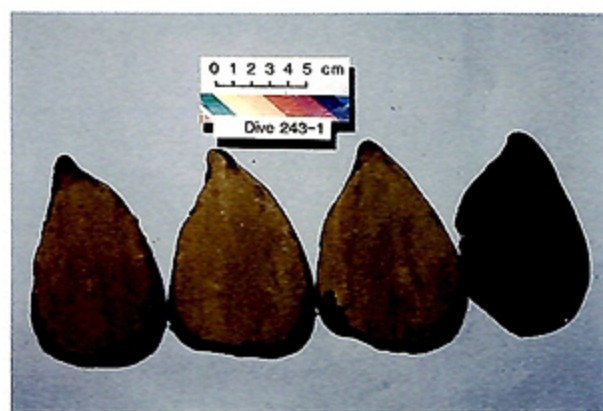
写真4 シルト岩(243-1)を岩石カッターでスライスした面 Photo. 4 Cut face of silt rock (243-1), sliced by rock-cutter.
