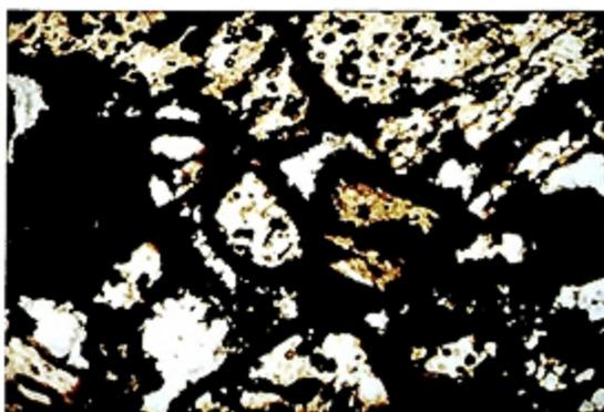
写真10 火山砂礫の薄片写真, 砂粒をうすくFeS
